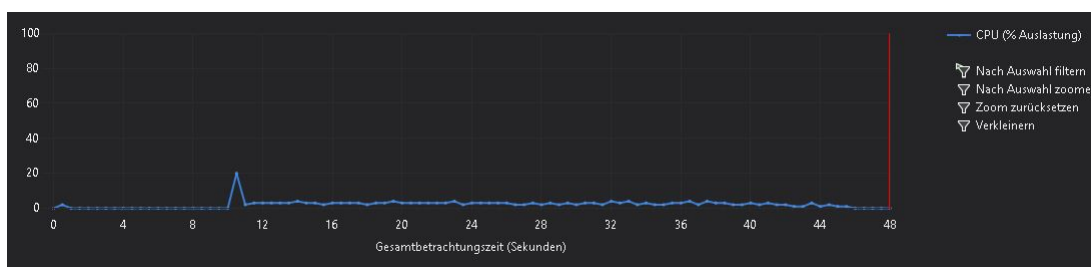
Abbildung 14: CPU-Auslastung bei kontinuierlichen Loginversuchen von 1000 parallelen Threads
